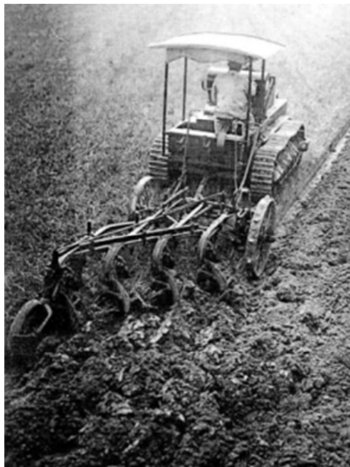
Tracteur Renault et attelage de charrue à socs multiples (Concours de Senlis - 1919) Cliché Gallica BNF
